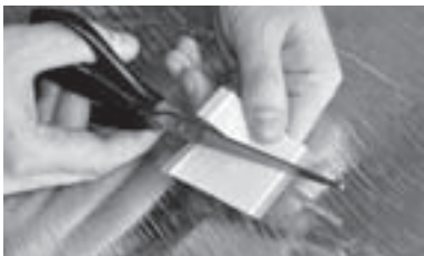
Рис. 7. Разрезание битумной изоляции на 2 части
